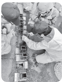
▲完成試験体への水張り・確認
