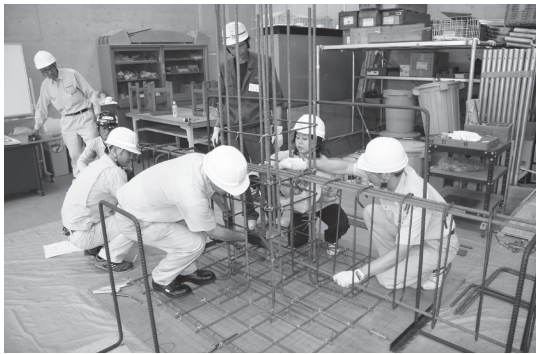
▶鉄筋技能士検定試験の課題に取り組み教諭ら(写真上)。座学では、指差呼称など安全確認の重要性を学んだ。
