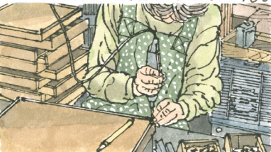
(9)まとめ・止め金具などを取り付けてまとめれば木製雑貨の完成。
