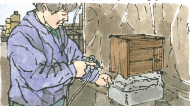
(7)仕上げ塗装・仕上げ用の塗料を吹き付ける。
