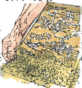
(4) 型送り・ひき粉まき 模様がずれないように型付けを繰り返しながら、糊を保護するためのひき粉を薄く。
